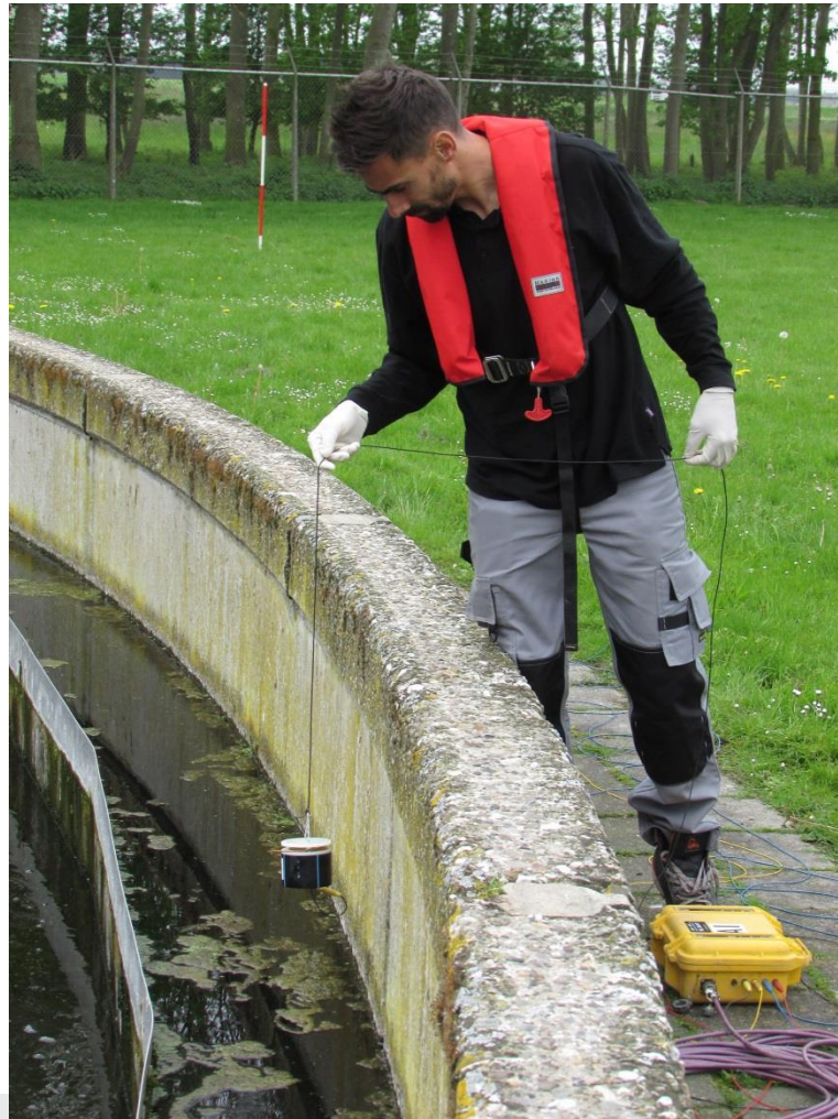
Foto: Aanbrengen meetelektrode.
